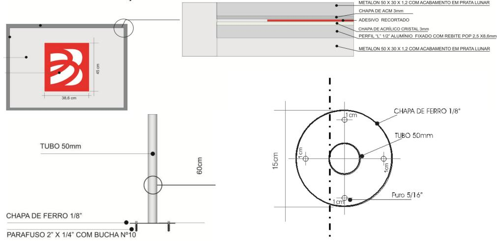
**Obs.:** A critério do Banco, caso seja necessário para a perfeita instalação, será solicitado que a sapata do módulo articulado seja confeccionada com uma secção, ou seja, no formato de semicírculo (conforme a figura acima).
