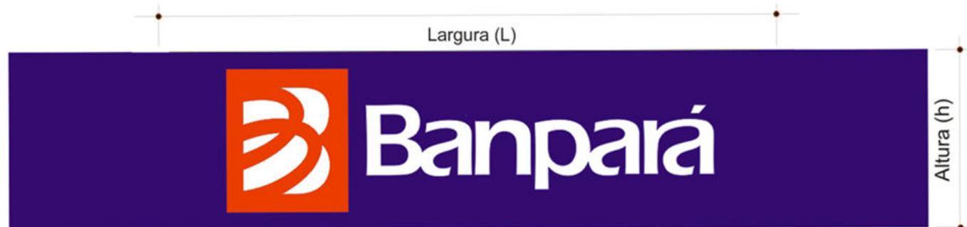
**A caixa luminosa:** em estrutura metálica (metalon 30 x 30 galvanizado).
